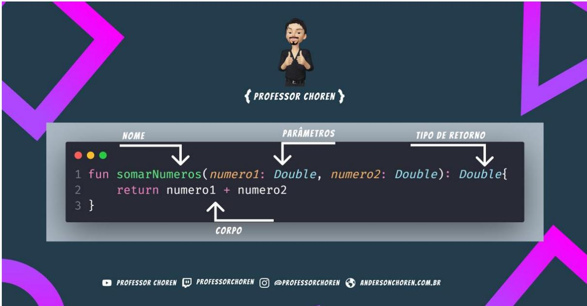
Figura 2.1 - Partes de uma função
